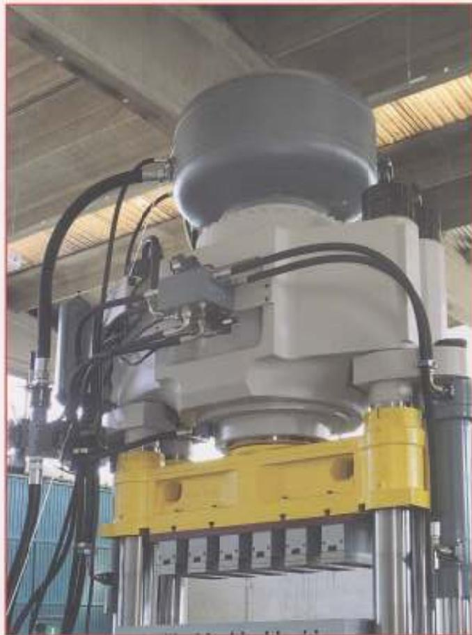
Le prese della serie "BRICK" sono progettate per la produzione di mattoni per refrattari e laterizi nelle misure standard o speciali, sia pieni che forati. Una delle particolarità di queste macchine è la possibilità di essere personalizzate a seconda delle esigenze del cliente.
